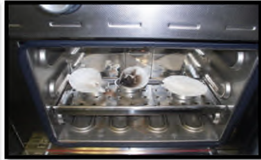
Photo B.5: Séchage des MES à 105°C.
