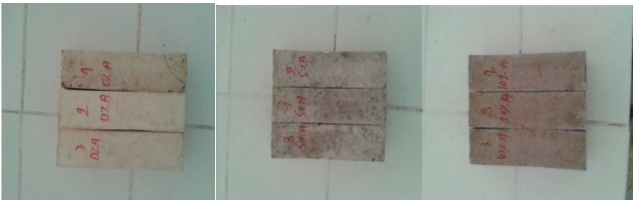
Figure V.5 : Spécimens des briques confectionnées cuites à 900 °C et à différent pourcentage d'ajouts (0%, 5% et 10%).
