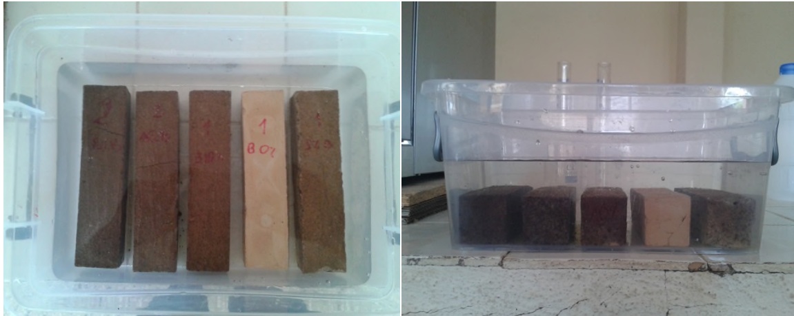
Figure V.10 : détermination du coefficient d'absorption d'eau (C%).
