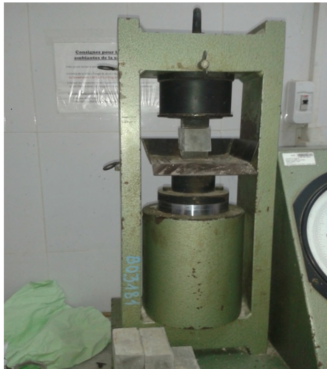
Figure V.14 : Essai de la résistance à la compression.
