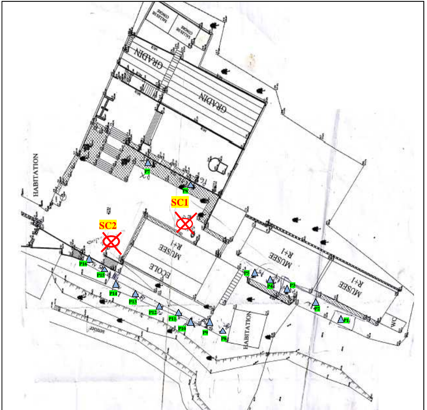
Plan d'implantation des points de sondage carotté et des essais au pénétromètre dynamique
