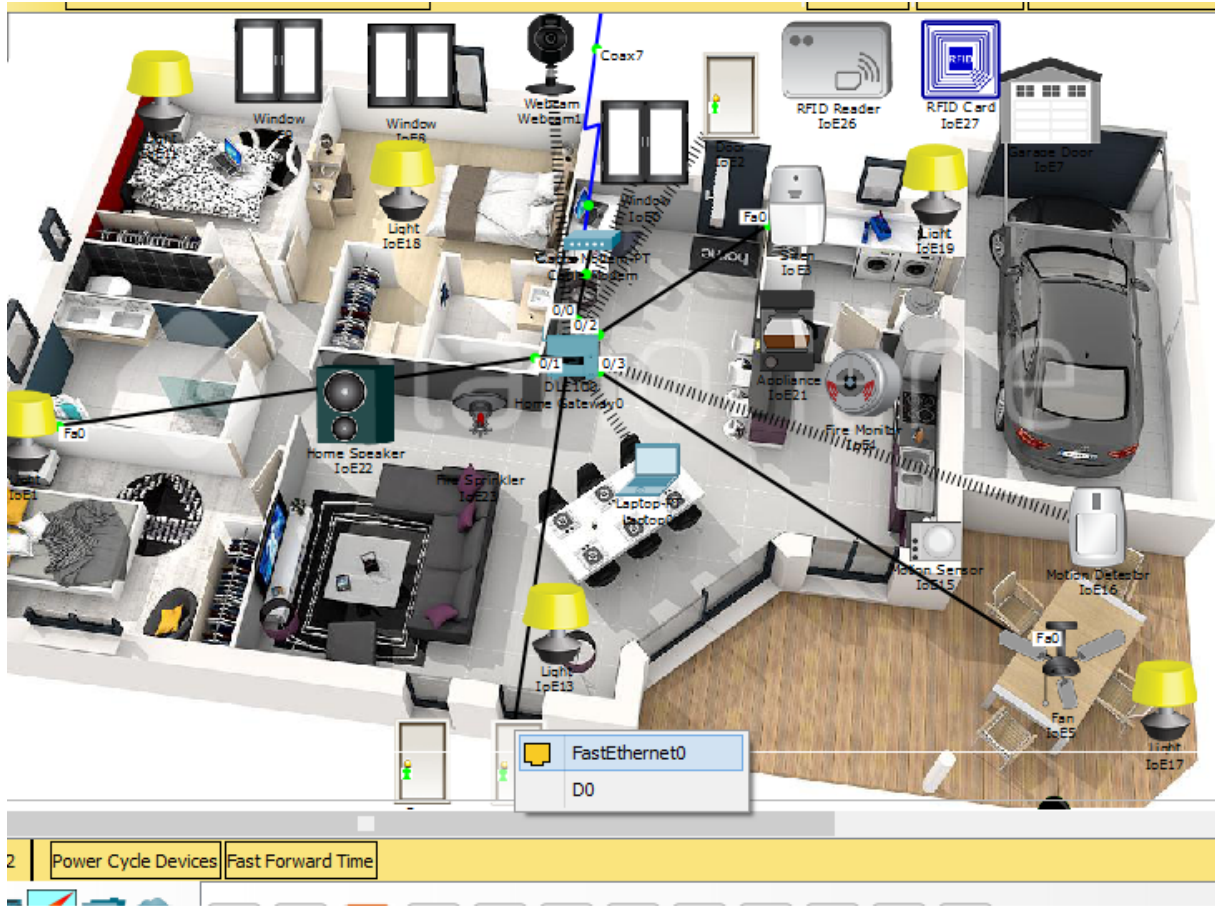
FIGURE 3.11 – Connexion des objets à la passerelle
