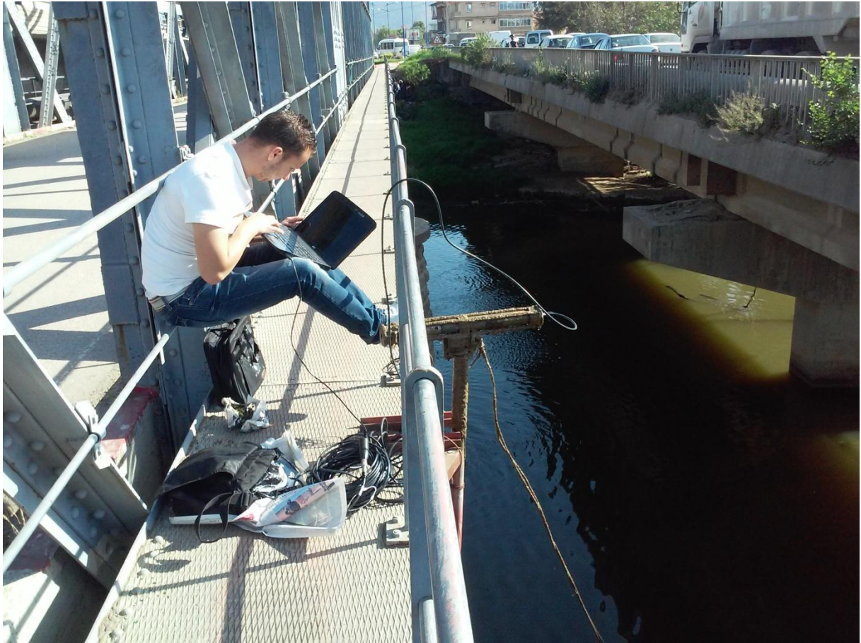
Figure 46: Récupération des données par pompage via le logiciel Win-Situ 4.
