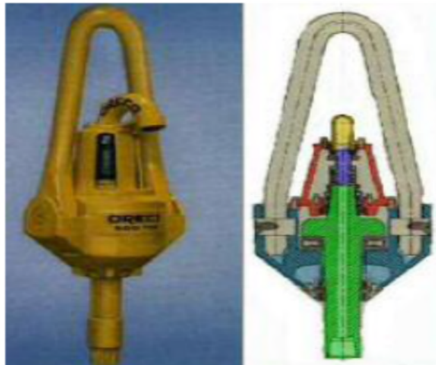
Figure II.33 : La tête d'injection.
