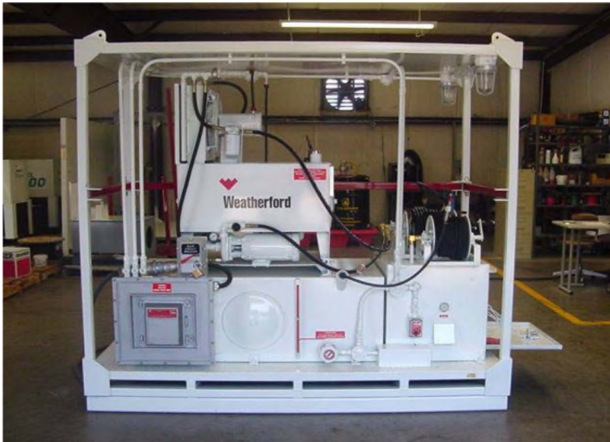
Figure III.8 : Unité standard de Puissance. [8]
