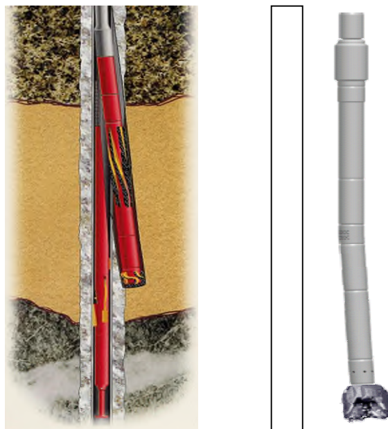
Figure II.54 : Le forage dirigé.
