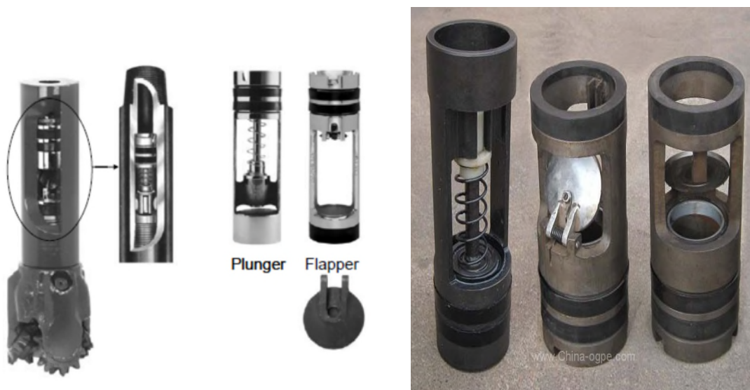
Figure III.7 : Tiges de forage avec vanne anti retour. [8]
