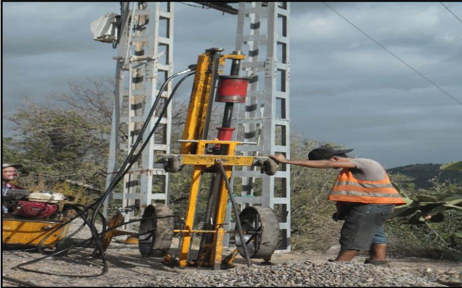
**Figure II.4 :** Réalisation de l'essai pénétrométrique (PDL).
