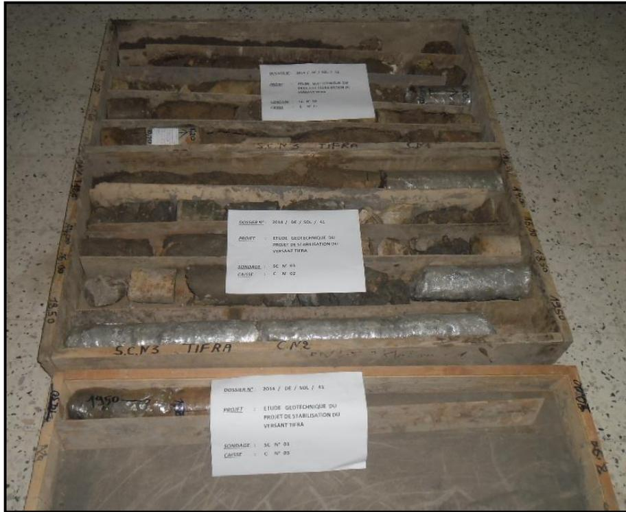
**Figure II.6 :** Les échantillons prélevés pour les essais du laboratoire (du sondage carotté SC03).
