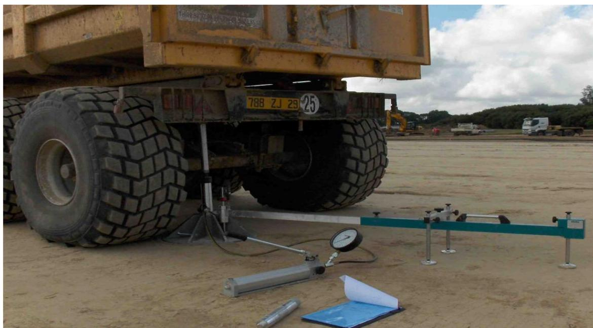
Figure I.20 : Essai de plaque.
