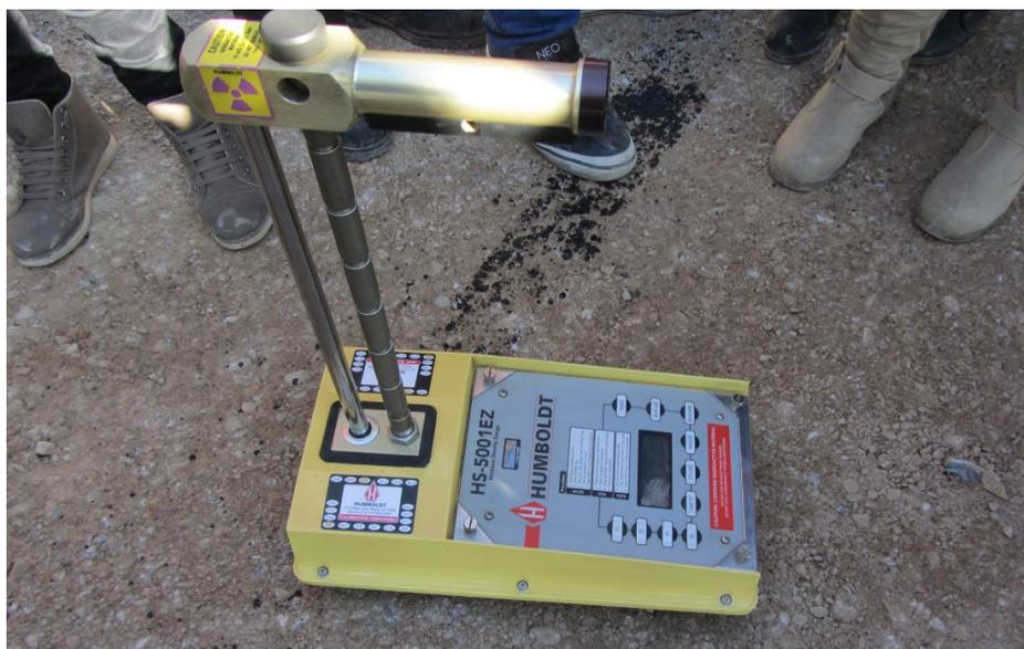
Figure I.22 : Gammadensimètre.
