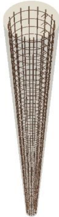
Figure. V.32. Schéma Ferrailage des pieux forés
