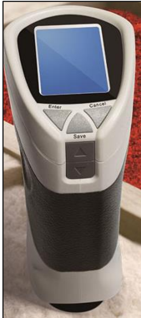
Figure III.6. Colorimètre pour mesurer la couleur dans le système L^*a^*b^* . (Photo prise : le 16 juin 2016)
