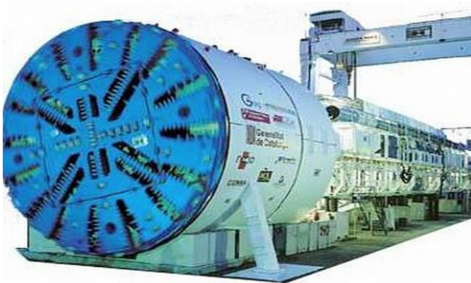
Figure II.4: Tunnelier à bouclier. [15]
