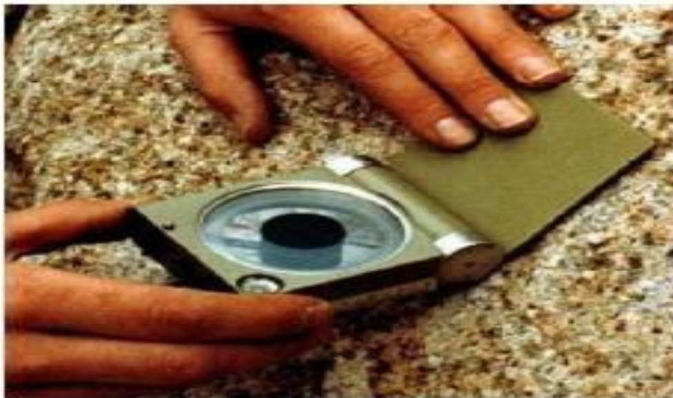
Figure I.12: Une boussole géologique pour mesurer le pendage et la direction du plan. [1]
