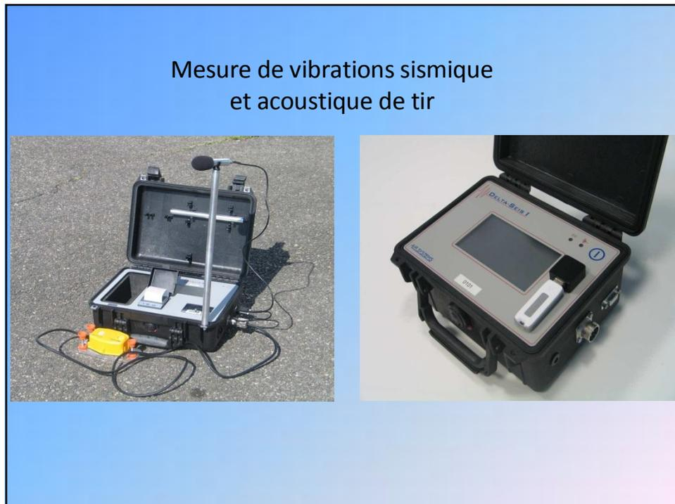
**Figure III.2.** Appareil de mesure DELTA SEIS 1 (géophone tri directionnels) [19].
