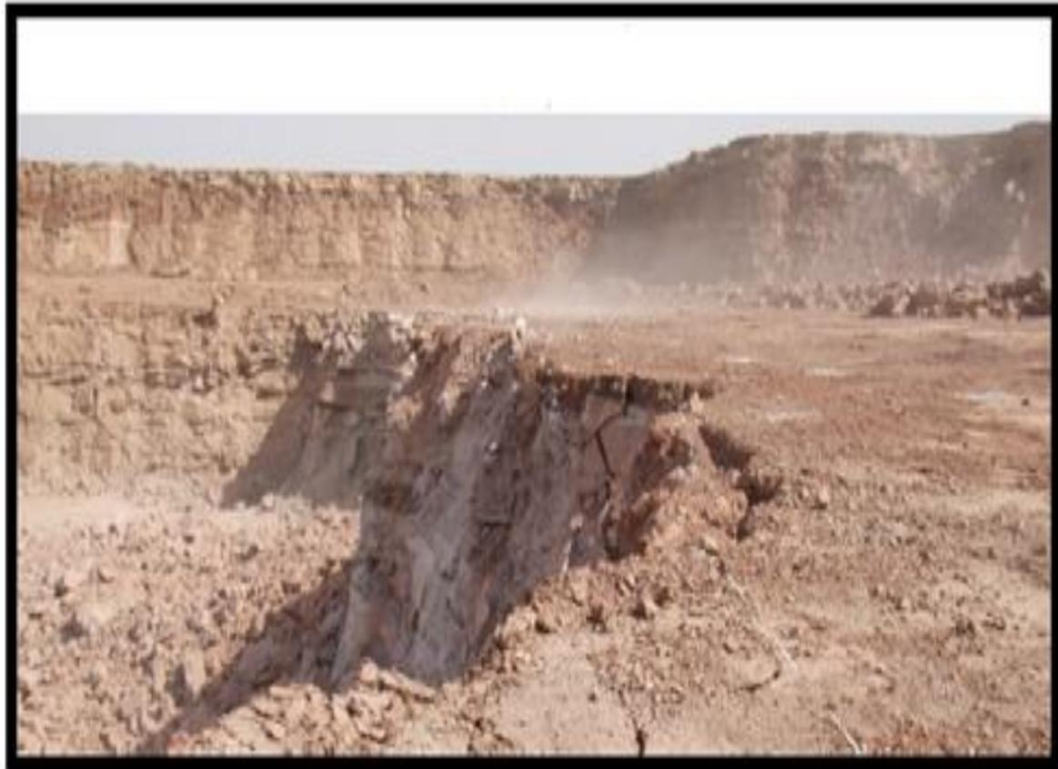
**Figure I.13.** Effet arrière constaté pour les essais bi-trous et multi-trous. [12]
