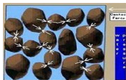
Figure N°25 : Réduction des forces de contact et augmentation de la pression interstitielle
