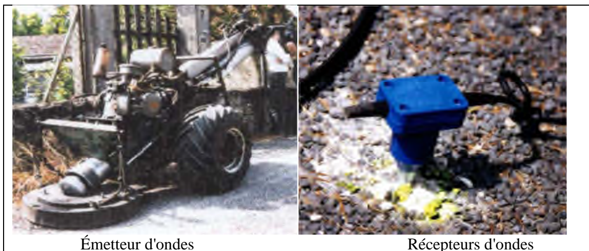
Figure II.3 : méthode de prospection sismique (document INSA, Toulouse)
