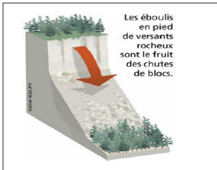
Figure I.8: Liaison entre les éboulements et les chutes de blocs
