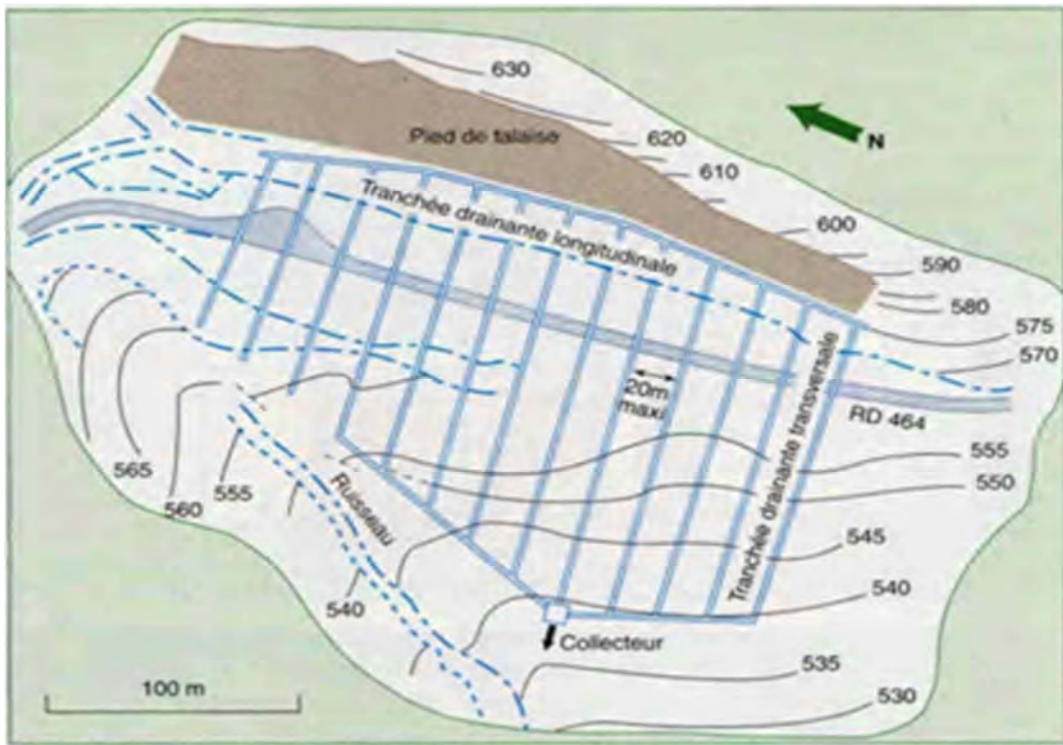
Figure III.10 : Drainage mis en œuvre sur le glissement de Vaocluse(Doubs) (d'après Faure et al., 1975).
