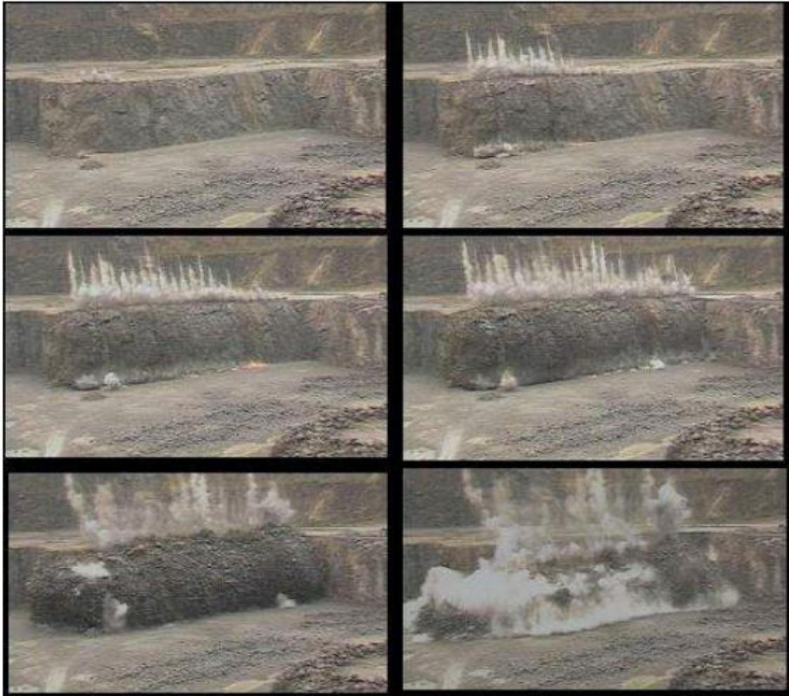
Figure I.02: Photos d'un abattage à l'explosif.[15]
