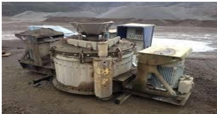
Figure II. 9. Concasseur à percussion à axe vertical. [20].
