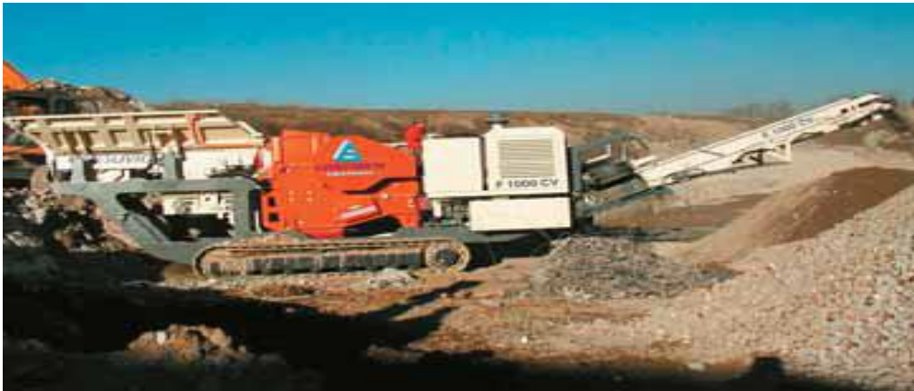
Figure II.11. Concasseur situé au niveau de la carrière [12].
