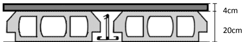
Figure II.1 : Plancher à corps creux
