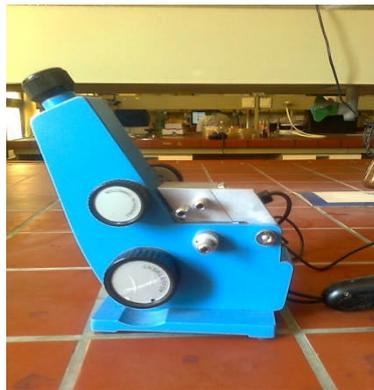
**Figure15:** Réfractomètre d'ABBE.
