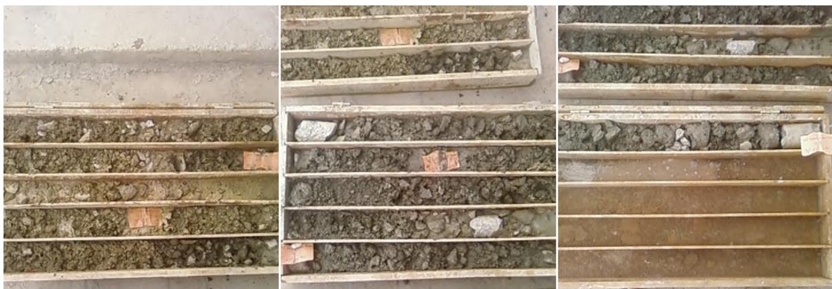
*Photos II.3 : Des caisses des carottes de sol du sondage.*
