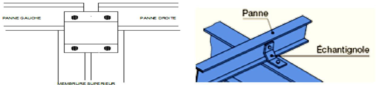
Figure VII.5 : vue de face et en 3D de l'échantignolle
