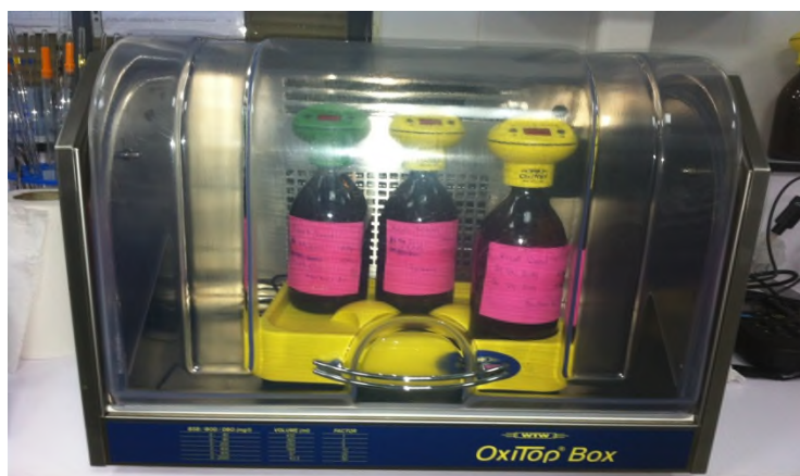
Figure III.4 : Appareil de mesure de la DBO 5 (OXITOP BOX).
