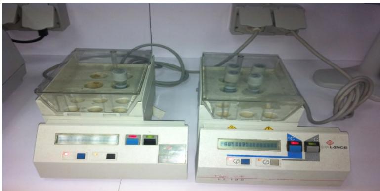
Figure III.2 : Appareil de mesure de la DCO (Thermostat HACH-LANGE).
