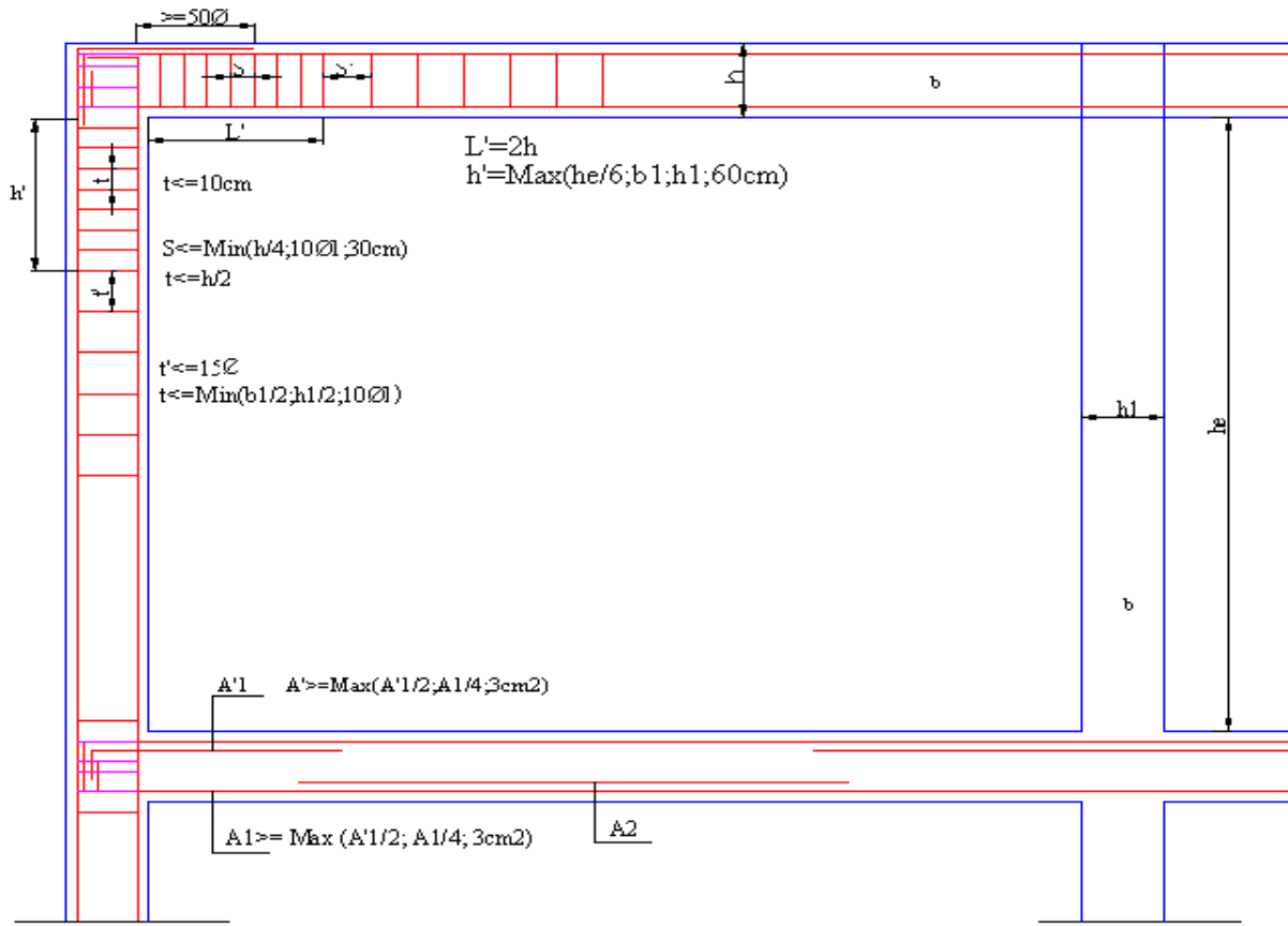
Figure V.1. Dispositions constructives des portiques
