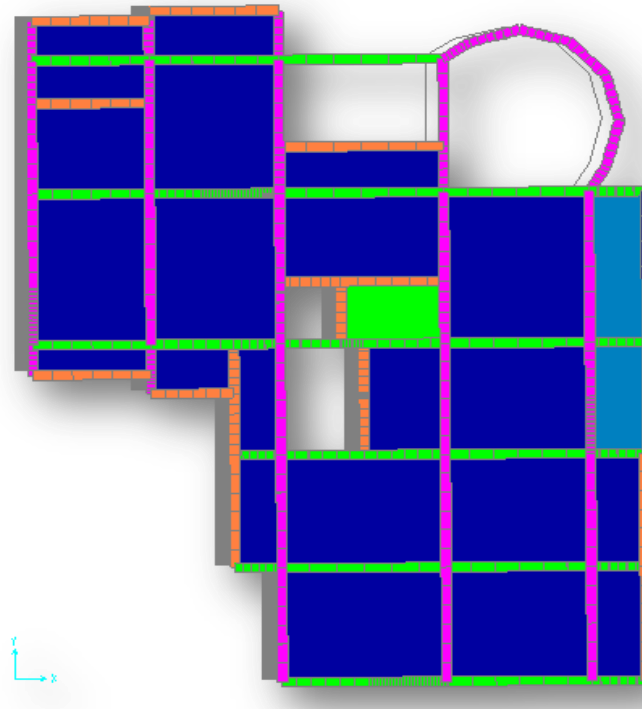
Figure4.4.mode2translation dans le sens x-x T=0.73s
