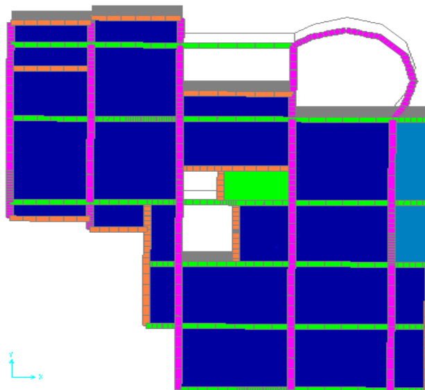
Figure4.5 mode 1 translation dans le sens y-y T=0.69 sec
