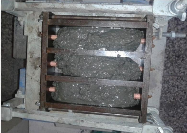
**Figure II.12 :** Confection des éprouvettes.
