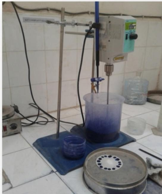
**Figure I.15** : Essai au bleu de méthylène.
