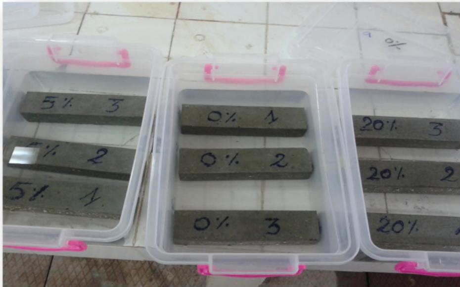
Figure II.15 : Conservation des éprouvettes dans l'eau distillée.
