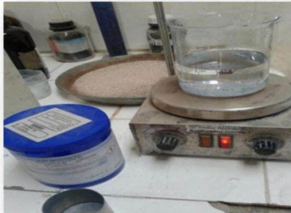
**Figure I.14** : Préparation de la solution de bleu de méthylène.
