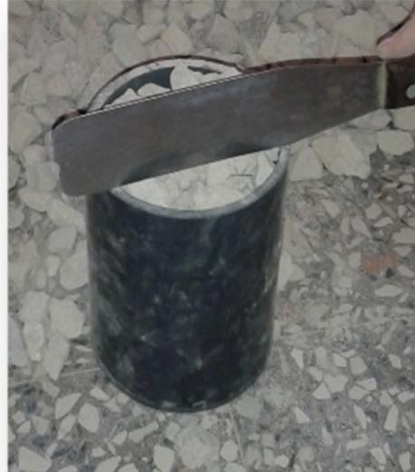
**Figure I.21** : Mesure de la masse volumique apparente.
