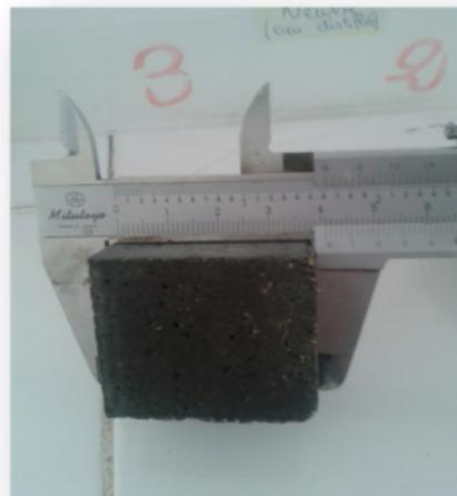
**Figure III.19 :** Mesure de la masse et les dimensions des cubes.
