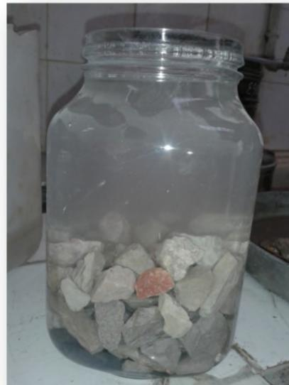
**Figure I.20** : Mesure de la masse volumique au pycnomètre.
