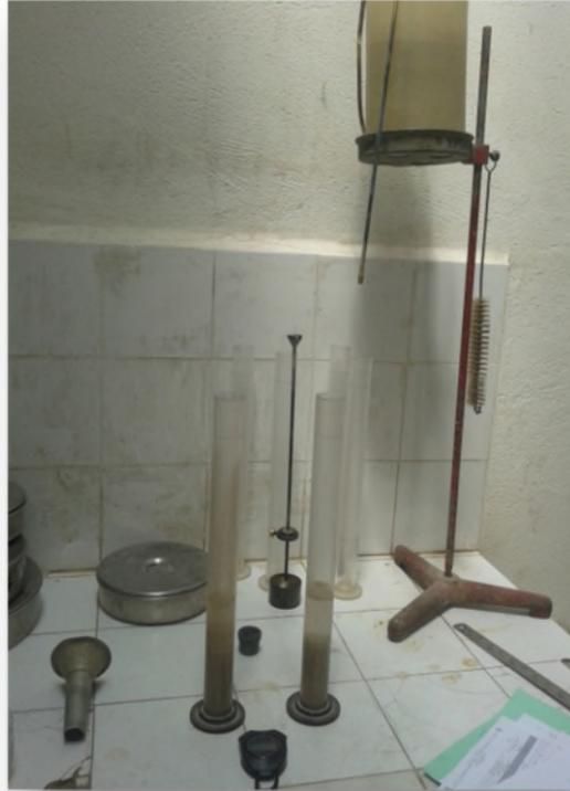
**Figure I.10** : Equivalent de sable.
