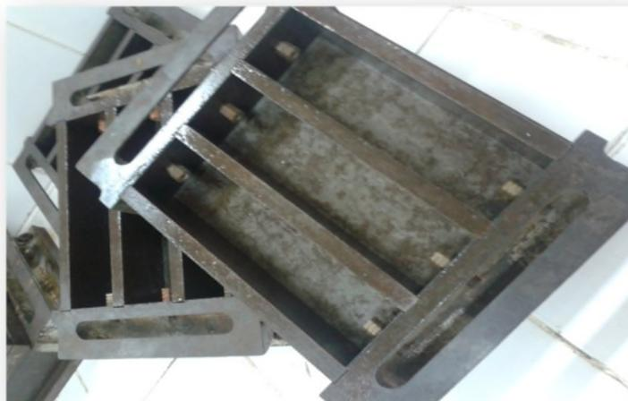
**Figure II.10** : Les moules prismatiques  $4 \times 4 \times 16 \text{ cm}^3$ .
