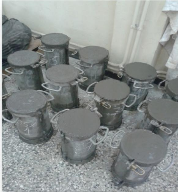
**Figure II.24 :** Confection des éprouvettes 16×32 cm<sup>2</sup>.
