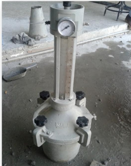
**Figure III.12:** Aéromètre à béton.
