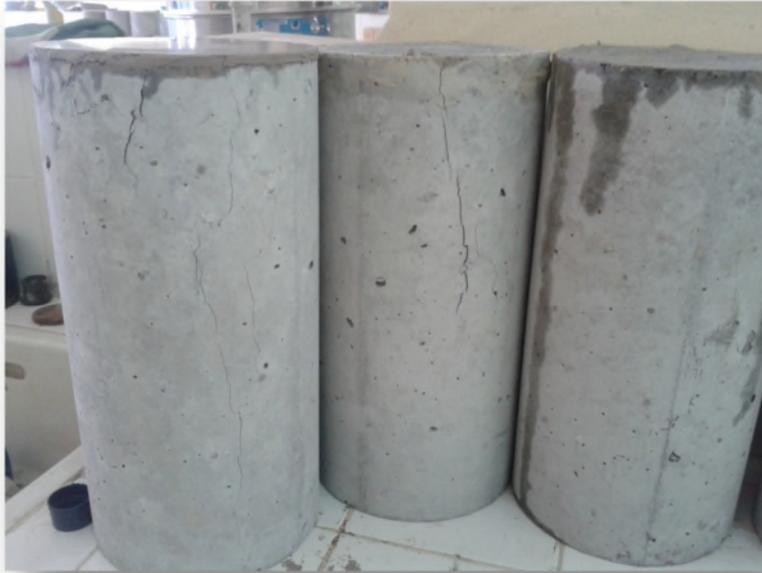
**Figure III.17 :** Fissuration des éprouvettes.
