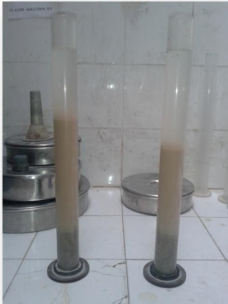
**Figure I.12 :** Equivalent de sable après lavage des échantillons.
