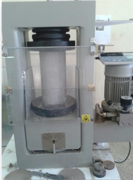
**Figure III.15 :** Presse pour béton.
