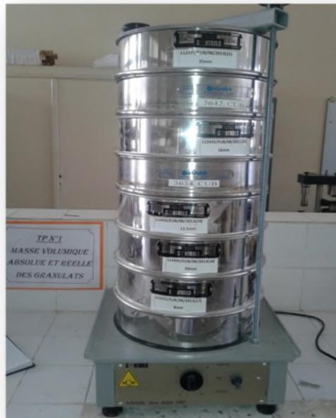
**Figure I.5:** Colonne des tamis.
