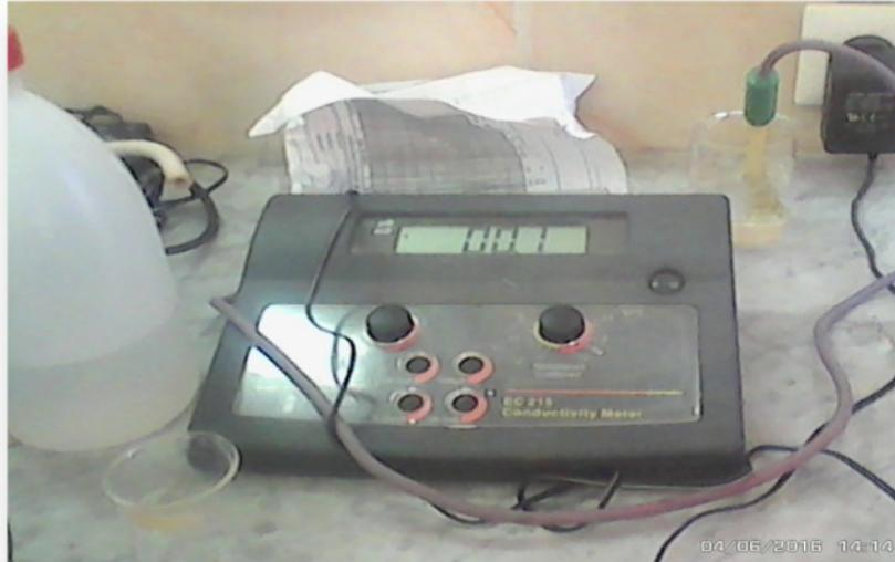
**Figure III.27 :** Appareil de mesure de PH et la conductivité.
