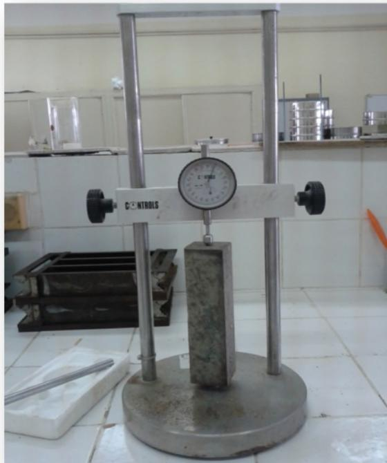
**Figure III.2** : Appareil de mesure du retrait et gonflement.
