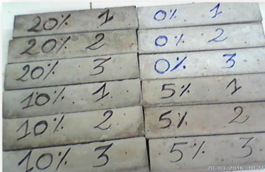
Figure II.16 : Conservation des éprouvettes à l'air libre.
