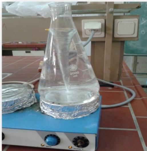
**Figure III.22:** Agitation de la solution de sulfate de sodium.
