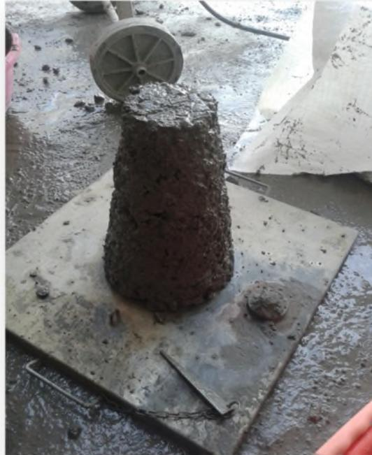
**Figure III.11:** Affaissement au cône d'Abrams.
