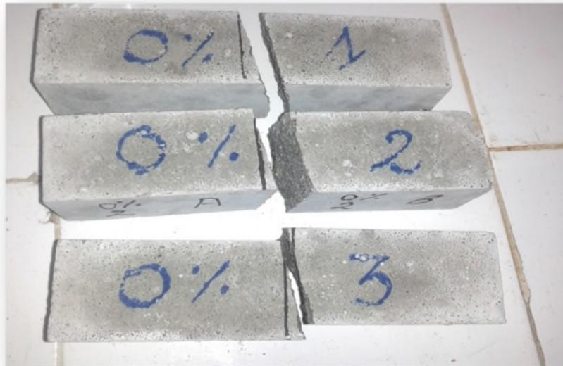
Figure III.5 : Rupture des éprouvettes prismatiques soumise à la flexion.
