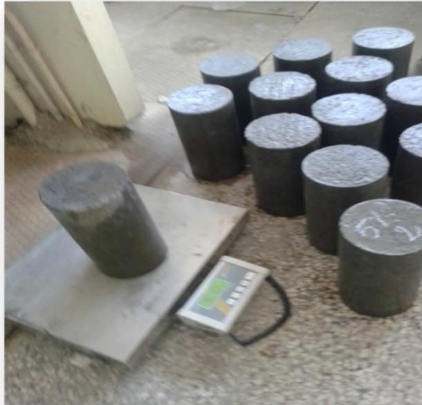
**Figure III.14:** Pesé des éprouvettes.
