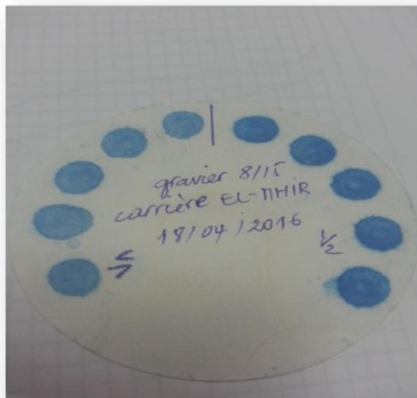
**Figure I.17** : Les résultats de l'essai à la tache du gravier 8/15.
