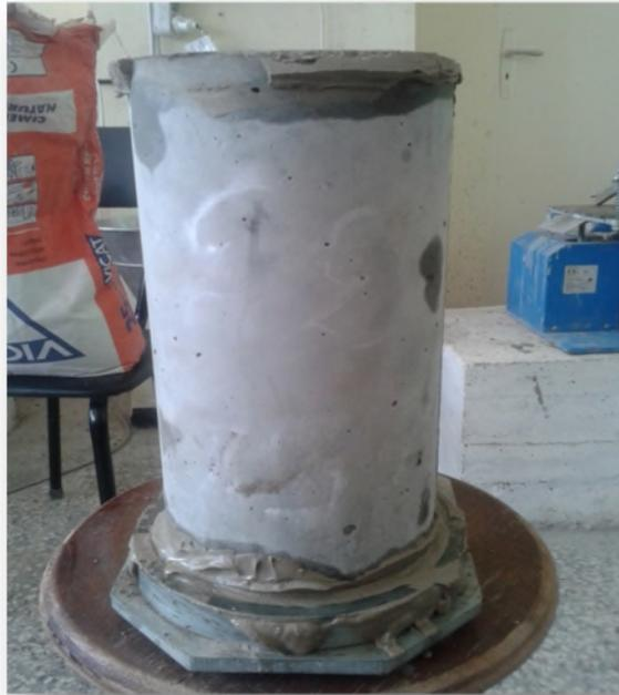
**Figure III.16:** Surfaçage des éprouvettes.
