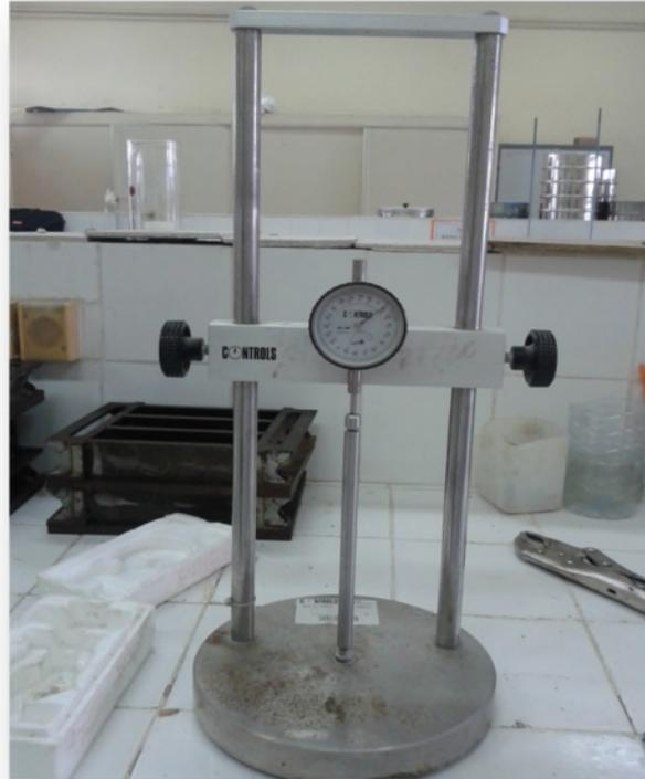
**Figure III.1** : Etalonnage de l'appareil de mesure du retrait et gonflement.
