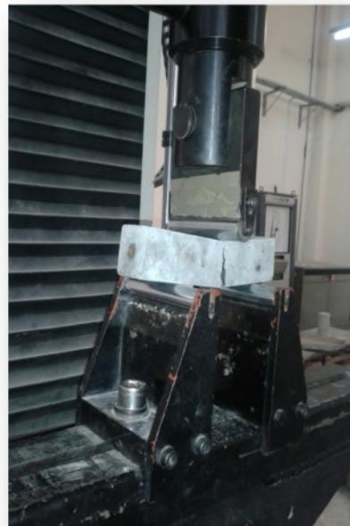
**Figure III.3:** Essai de résistance à la flexion.
