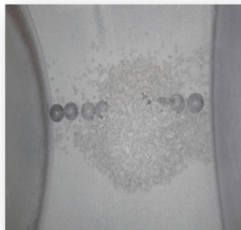
**Figure I.22** : Principe de l'essai Los Angeles.
