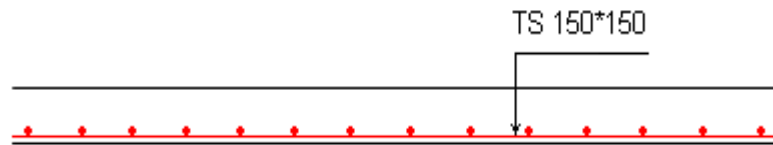
Figure III.26 : Schéma de ferrailage de la dalle de compression
