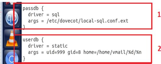
FIGURE 4.36 – Configuration de l’authentification dans dovecot.
