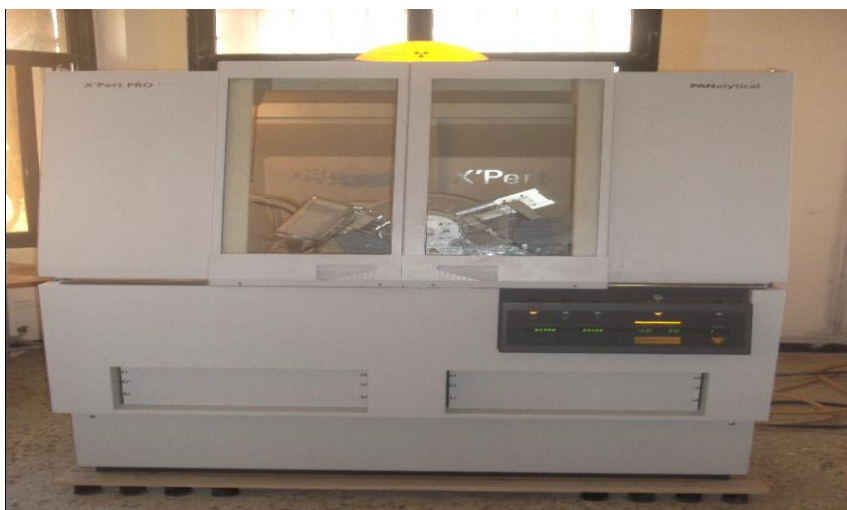
Figure III.13: Appareille de DRX au niveau de laboratoire de GP à l'université de Bejaia.
