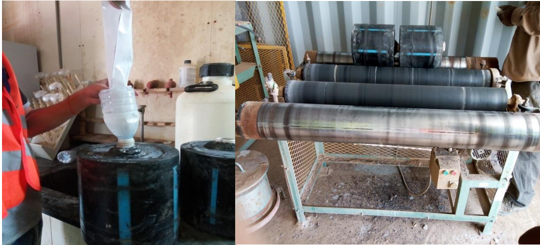
Figure III.7: Protocole de bouteilles roulantes [Photo prise].
