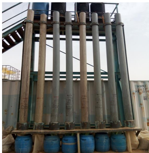
Figure III.4: Préparation des colonnes de lixiviation [Photo prise].
