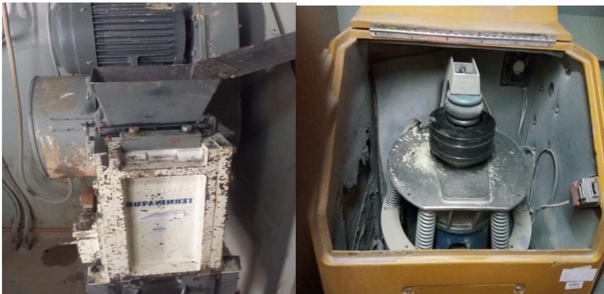
Figure III.8: Préparation mécanique (concassage, broyage) [Photo prise].
