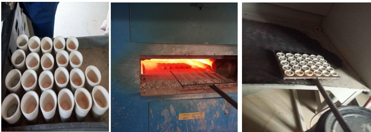
Figure III.9: Préparation thermique des échantillons au niveau de laboratoire [Photo prise].
