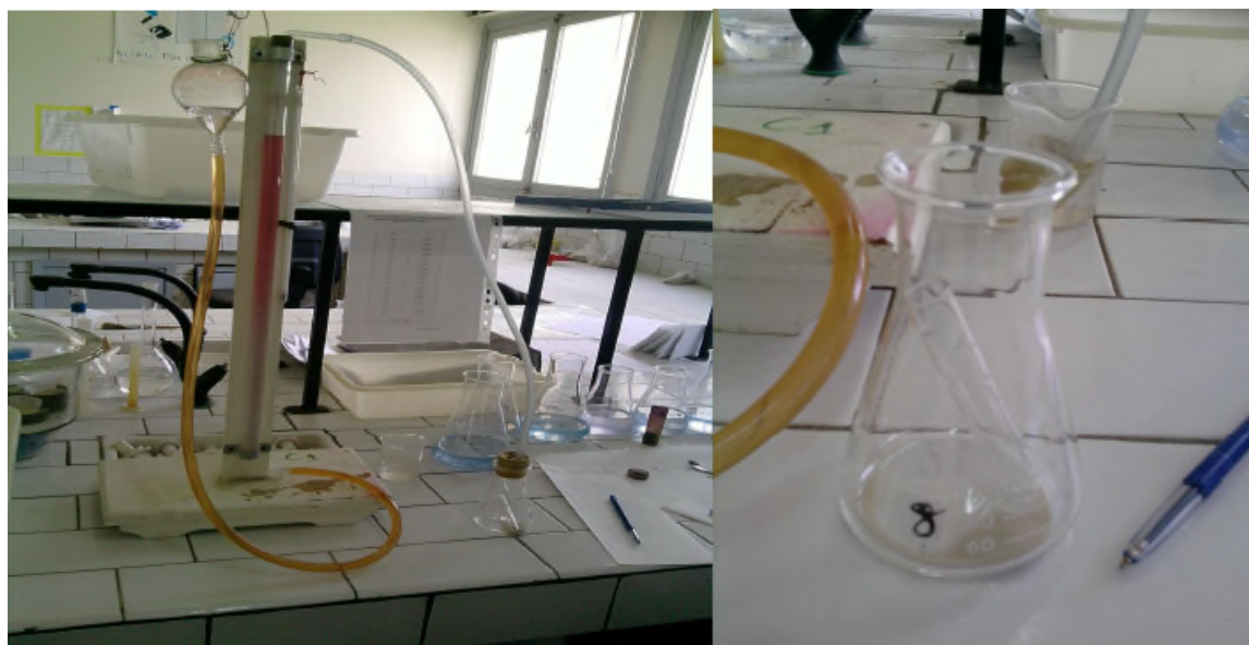
Figure 21 : Schéma de Calcimètre de BERNARD
