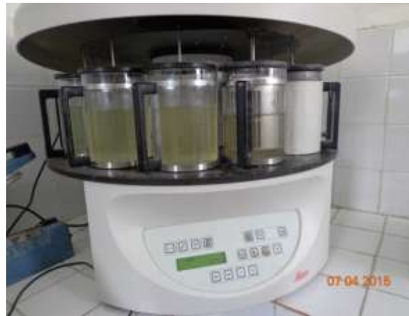
Figure15 : L'automate permettant la déshydratation, la désalcoolisation et l'inclusion (photographie originale).
