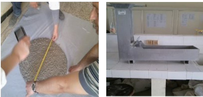
Figure 32 : L'ensemble des essais effectués sur le béton frais
