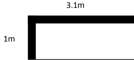
Fig.II.3 : dalle sur deux appuis
