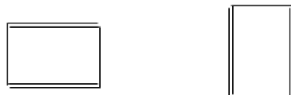
Détail d'un cours d'armatures transversales de la zone nodale
