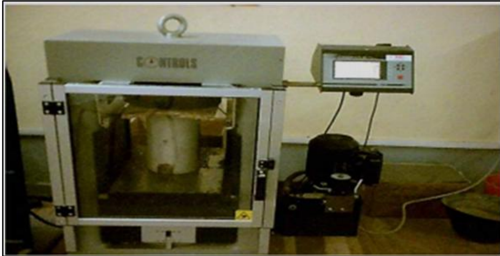
Figure V.8. Le matériel utilisé dans l'essai de compression du béton [16].
