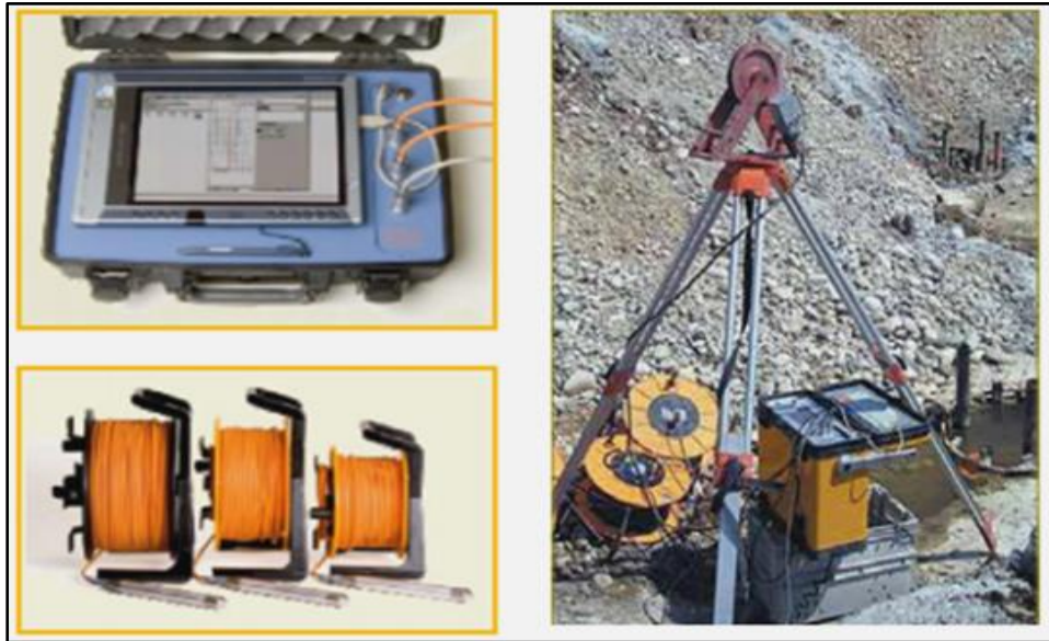
Figure V.4. Matériels d'auscultation sonique[14].
