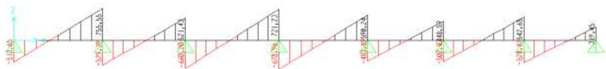
Figure VI.8 : Diagramme des efforts tranchant à l'ELU.
