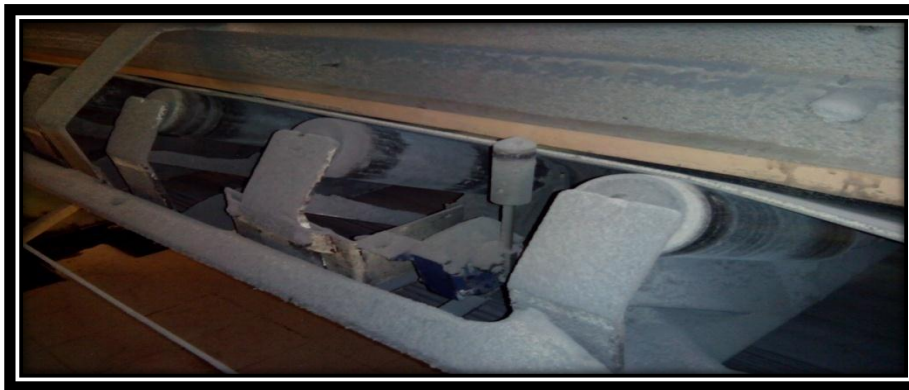
Figure IV.3. Problème de déport de band
