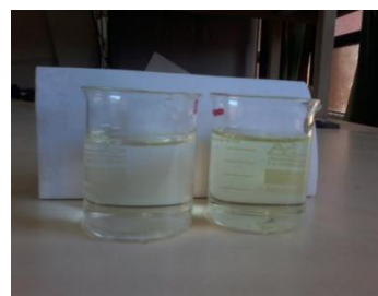
Figure IV-13 : (a) Evolution du taux de dégradation des colorants BM, MO et JB en fonction du temps par les films minces de \text{MnO}_2/\text{Ti} . [\text{BM}] = [\text{MO}] = [\text{JB}] = 6,25\mu\text{M} , pH 1,8 et E = 2 \text{ V/ESS} . (b) Images des solutions avant et après traitement électrochimique.
