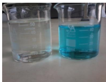
Figure IV-13 : (a) Evolution du taux de dégradation des colorants BM, MO et JB en fonction du temps par les films minces de \text{MnO}_2/\text{Ti} . [\text{BM}] = [\text{MO}] = [\text{JB}] = 6,25\mu\text{M} , pH 1,8 et E = 2 \text{ V/ESS} . (b) Images des solutions avant et après traitement électrochimique.
