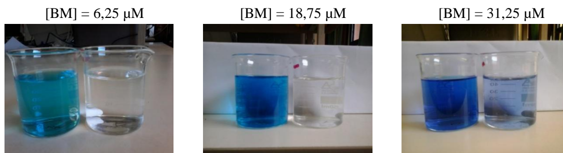
Figure IV-11 : (a) Effet de concentration initiale de BM sur la dégradation de BM ( 6,25\mu\text{M} ) par interaction avec les films minces de \text{MnO}_2/\text{Ti} en fonction du temps. (b) Images des solutions de BM avant et après interaction.
