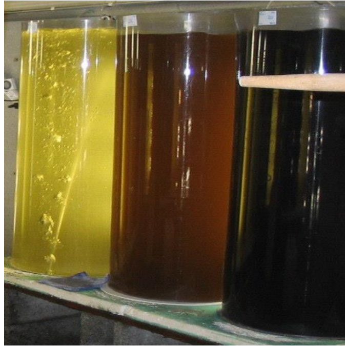
Figure 12- Photobioréacteurs de type colonne à bulles (Scobalit) utilisés classiquement en Ecloserie [11]
