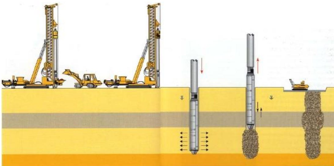
Figure II.5 : Mise en œuvre des colonnes ballastées par voie sèche [11].
