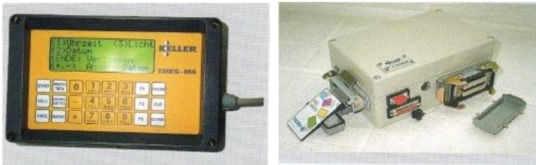
Figure II.6 : Clavier et unité centrale de l'appareil de mesure M4 [11]
