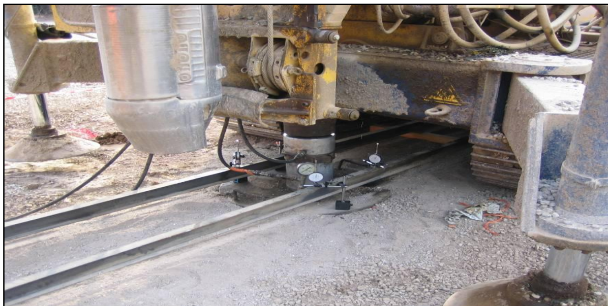
Figure VII.3 : Dispositif d'essai de chargement d'une colonne isolée
