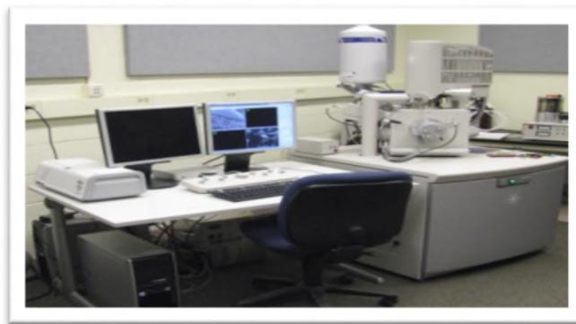
**Figure IV.5.** Photo d'un appareil MEB environnemental FEI Quanta 200 FEG.
