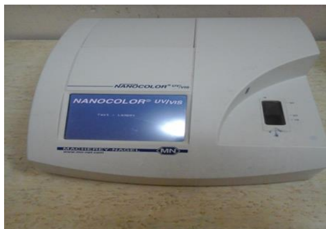
Fig.II.2. Spectrophotomètre NANOCOLOR UV/VIS Macherey- Nagel.
