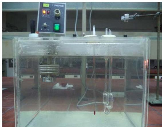
**Figure II.6:** Montage utilisé pour la détermination de la viscosité.
