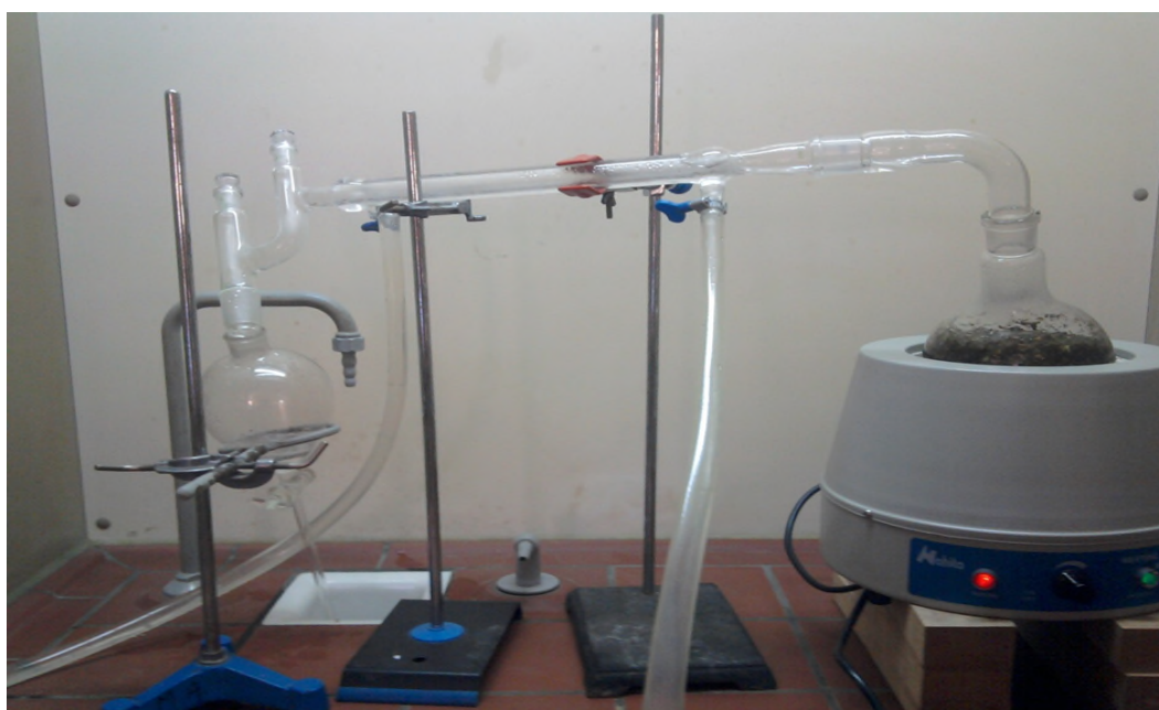
Figure n° 5 : Photographie du dispositif d'hydrodistillation
