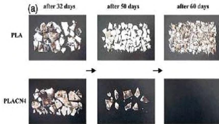
**Figure II.10** : Dégradation accélérée d'un PLA en présence de 4% d'argile [42].
