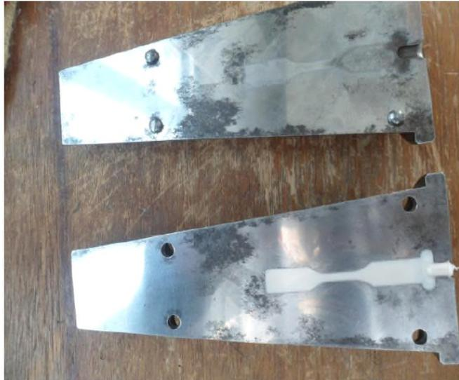
**Figure IV.3** : Vue de face de l'éprouvette dans un moule ouvert.
