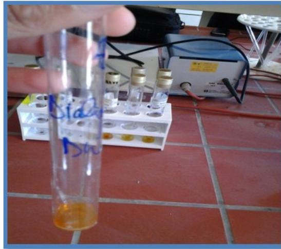
**Fig.12** : Réaction du réactif de Nessler avec l'ammoniac
