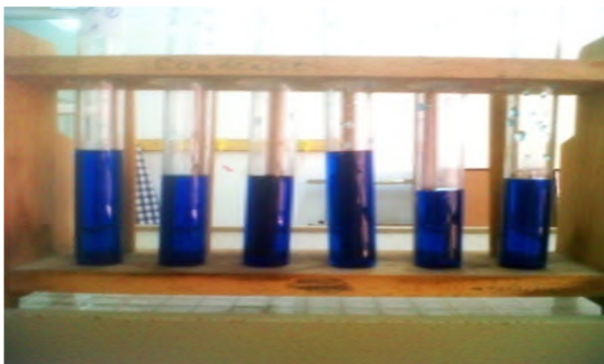
Fig.III-17 Image de la solution bleu de Méthylène préalablement traitée avec l'argile de Semaoun.
