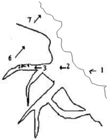
Figure. I.2 : Les différentes étapes de transfert dans un solide poreux [10].
