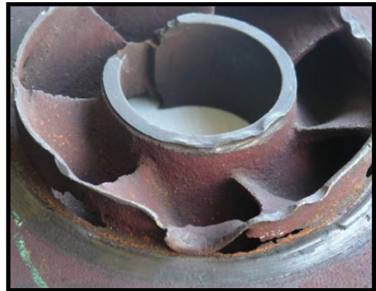
Figure (IV.5) : Effet de la cavitation sur la roue
