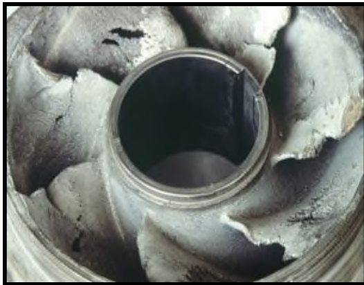
Figure (IV.5) : Effet de la cavitation sur la roue
