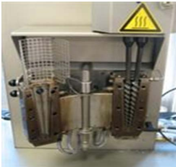
Figure 19 : Extrudeuse bis-vis de type micro compounder DSM Xplore modèle 2005.
