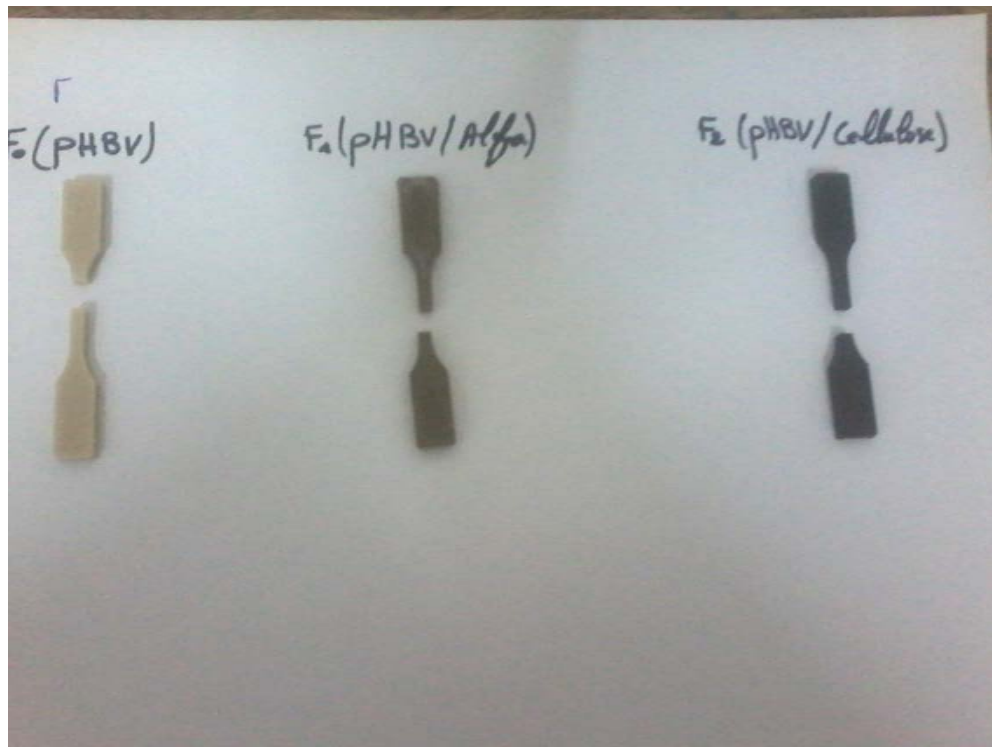
Figure 27 : Clichés des éprouvettes après traction pour des composites présentant différents type de renfort.
