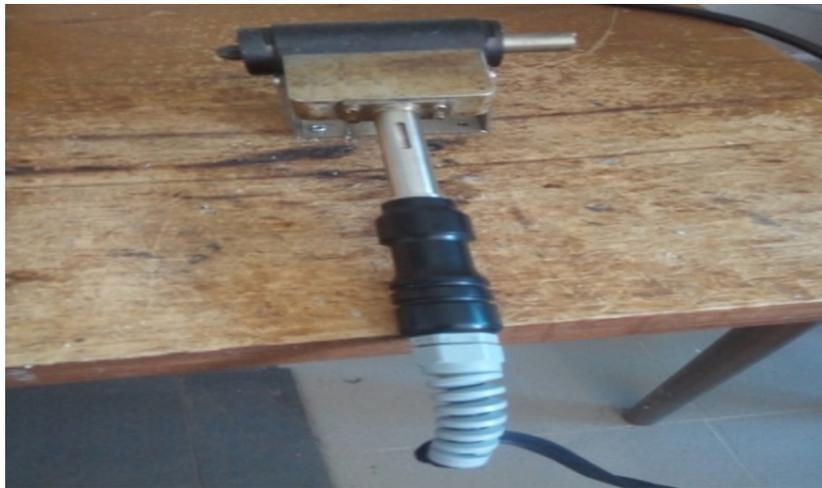
**Figure I.4:** Représentation du port échantillon.
