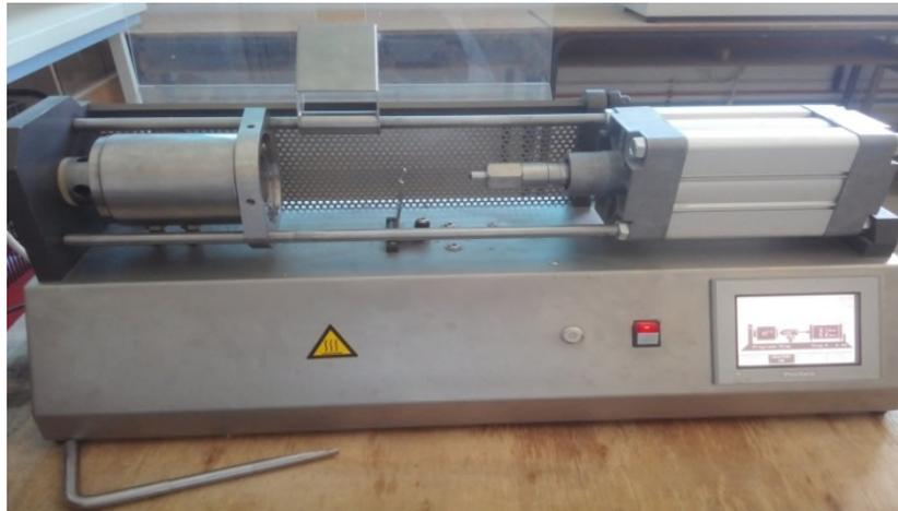
**Figure I.3:** Représentation de la presse à injection.
