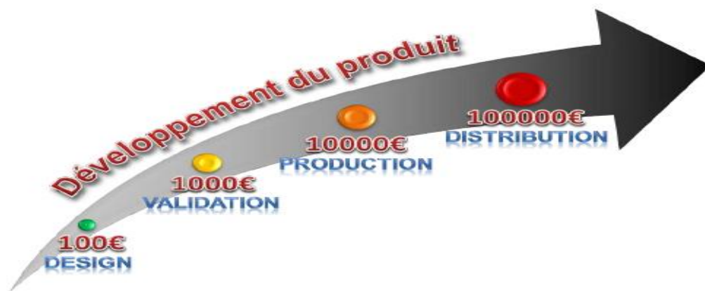
Figure III.2 : "Règle des 10" : Coût fictif de la découverte d'un problème de fiabilité en fonction des étapes de développement d'un produit [34].
